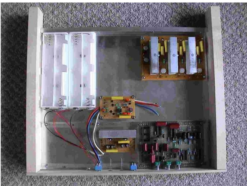
さらに悩んだのが、モータコントローラとドライブアンプを納めたボックスの形状と、配置方法です。結局上の写真にあるように、400x300mm のアルミ板をシャシとし、補強アングルと、残りの板材を使って、簡易ケースを仕上げました。ヨーロッパの側板の強度が十分なので、このコントローラボックスの上にターンテーブルボードを乗せても大丈夫そうです。いかんせん、プレーヤを置くスペースが限られているので、工夫が要ります。
