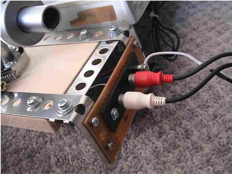
プレーヤ出力は直のケーブルとせず RCA ジャック出力としました。アンプへの配線が楽なのと、後日いろいろ他のケーブルを試してみたいという考えからです。
