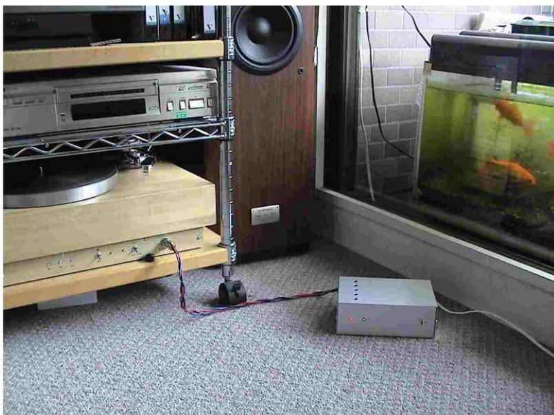
充電中の様子。ターンテーブルのフロントパネルの充電入力コネクタにケーブルを接続。バッテリーが空になっていれば緑色のランプが点灯します。ターンテーブル動作中の電流は  $160-170mA$  程度ですから、充電電流を  $260mA$  とすれば、1時間のレコード演奏あたり、40分ほど充電して補う、という使い方になるのでしょうか。。。
