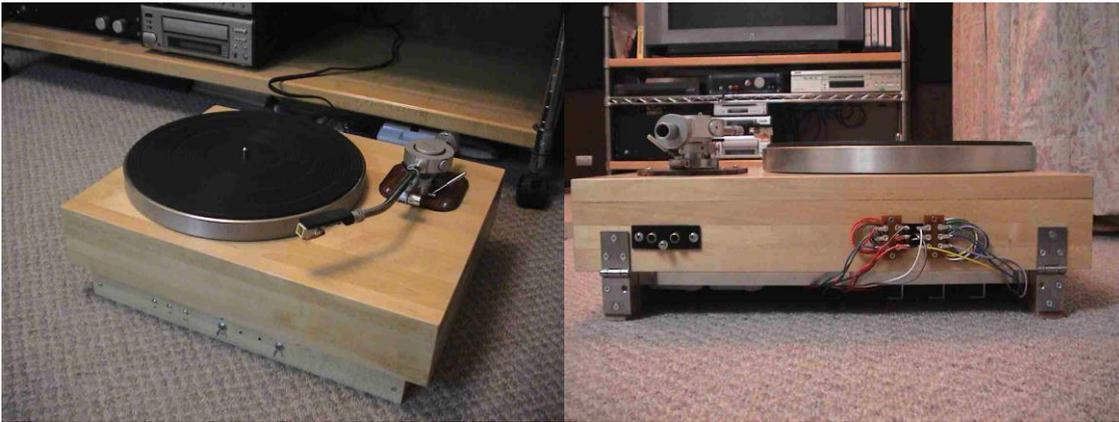
ターンテーブルの定速回転動作はとりあえず確認できました。音を聴いてみたい！ってんで、早速トーンアームを実装しました。左がトーンアームを実装して完成した DC 制御 SP-10 プレーヤの全景です。アームの固定方法は、スケルトンプレーヤ時代に編出した「ガスホースバンド方式」。ただし、今回はあくまで「木」にこだわりました。トーンアームの支柱(20mmφ)を囲むようにサクラ材製 15mmφ / 10mm 厚の「コマ」(ハンズで見つけた。中心に 3mmφ の穴が明いている)を3つ、5mm 厚の紫檀の板にネジで固定。これを支えにしてアーム支柱の垂直出しをします。あとは、ホースバンドで、コマ3つごと支柱を締め上げればできあがり。思いのほかがちりと仕上がりました。できあがったこのアームボードを、プレーヤボードにネジ止めし、後側の RCA ジャック端子にカートリッジの出力を接続しました。(右上写真参照)
