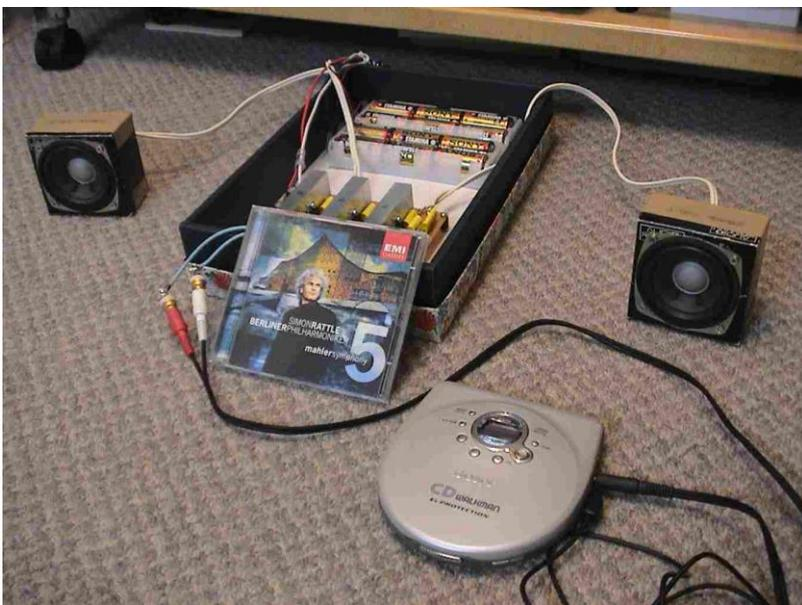
はて？モータードライブアンプとしての性能はどうやって見極めるのだろうか？一応、全ての配線などチェックが済んだ基板を前にしてしばしば考え込んだ。んで、安易ですが、ポータブルのCDプレーヤと、モニター用のスピーカを接続し、サイモン・ラトルさん指揮のマーラー5番の試聴と相成りました。このモニタスピーカは、アンプの改造／試作のたびにこれまで幾度となく使用してきたものです。口径は7.5cmと小さいですが、8Ωで30Wの耐入力があり、しっかりしたマグネットと磁気回路を持っています。普段は、寝室にある自作のFMレシーバに繋がっているのですが、ちょっと失敬して。。。プチッとスイッチオンしました。ポコ音もせず、サーっというノイズも出てこないの、ありゃ？と思っているうち、CDがスタートしました。おもむろ
