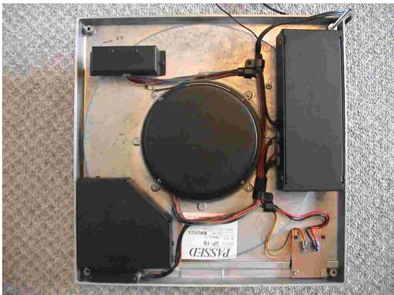
スイッチボックスをまるきり入れ替えた後の SP-10 裏側です。中心の黒い円形のカバーが、モーター本体です。左上の小さな箱の中身は、3個のパワートランジスタか、あるいはサイリスタのようなものでした。3組のコイルに3相の駆動電流を流す素子ではないかと思えます。右上の細長くて大きめのボックスは、スプリングで釣り下げられており、重量もあります。きっと電源トランスが入っているのでしょう。左下の三角のボックスには、ネオンランプとミラーを使ったストロボ式速度確認機構と、速度調整ポリウムが入っています。
