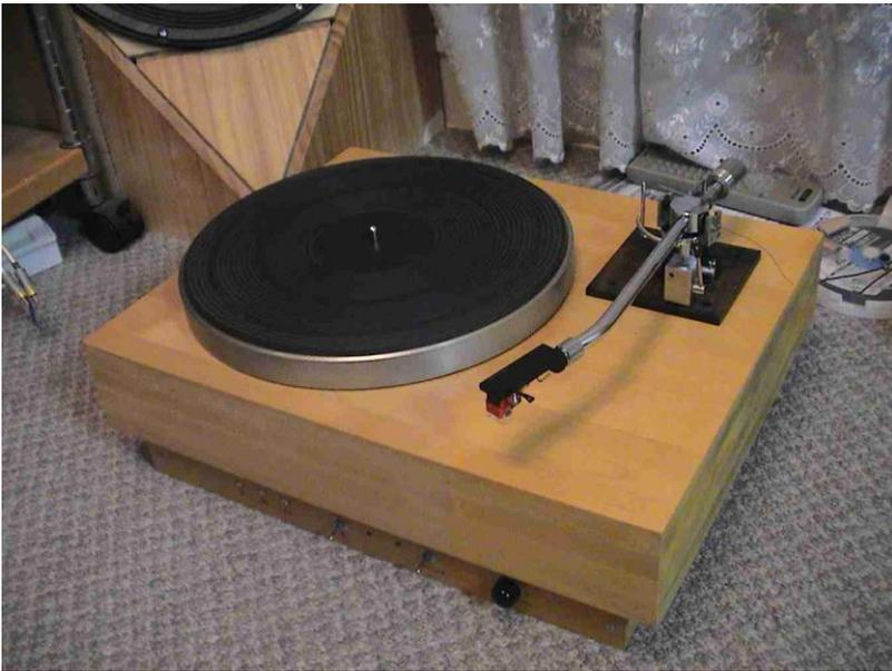
次に、アーム固定用の台座(プレート)です。これには、厚さ5ミリの黒壇の板を用いました。固定リングの入る径は30ミリですが、この穴明けに手間取った。お嬢の学校用彫刻刀も動員して、苦勞の末加工完了。ターンテーブルのセンタースピンドルからの距離を慎重に測りつつ、最後はエイヤで穴の位置を決めてしまいました。台座の下には分厚く大きな固定ナットがありますが、このナットがボードの座ぐり穴一杯になり、当たってしまうのです。詰めが甘いというか、あいかわらずアバウトなおるさんですな。。。それでも、針先の位置は、指定のオーバーハング距離に大体あわせることができました。メデタシメデタシ。
