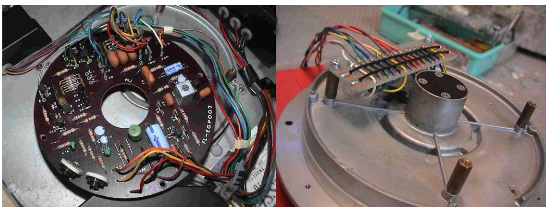
左上の写真は、SP-10 モータの裏側にマウントされているオリジナルの制御回路基板です。四角いコイルが見えますが、位置信号用の発振器部分でしょうか？右側が、この回路基板を切り離して、モータ本体から出ている配線の中継するために新しくユニバーサル基板を配置したところです。DC 制御に使わない配線もこの中継基板にハンダ付けし、プラプラ遊ばないようにしておきます。モータとターンテーブルを乗せ、さきほど説明したように光学 FG が動作するかどうかチェックしました。
