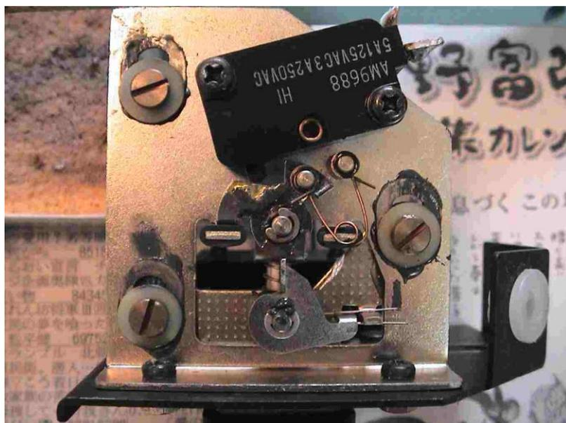
このボックスの中には、電源スイッチ(四角いボタンによるプッシュオン/プッシュオフ動作)と、33回転/45回転切り替えスイッチ(丸いツマミ)が入っています。良く考えてみると、30年前はさほどスイッチなど電子パーツのバラエティもなかったのでしょうか。上の写真のように、中身はマイクロスイッチを流用した芸術品に仕上がってます。ボタンを押す度にこの写真中央に見える金属片が左右にフリップ/フロップし、マイクロスイッチのタブを押し込んだり、解除したりします。金属片の動きはおかしくないのですが、どうやらマイクロスイッチ内部の問題のようです。分解前の動作中、この部分から「ジー」というノイズも出ており、微妙にターンテーブルに振動を伝えているように思えました。
