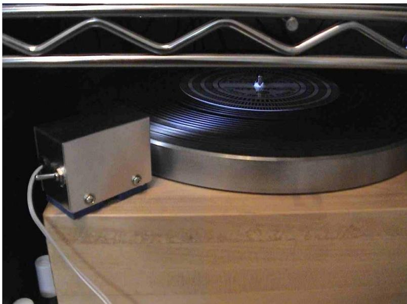
実際に使用しているところ。ターンテーブルボードの端にLEDランプユニットを寄せ、ストロボパターンを照らします。実際にターンテーブルを回し、33rpmと45rpmを切り替えて様子を見ます。今まではターンテーブル本体をラックから引き出し、天井についた蛍光灯の真下に置いて回転数のチェックをしていたのですが、これなら世話いらすです。しかも、至近距離から照らすので、ストロボの像が滲まず、視認しやすくなりました。肝心の回転数ですが、ストロボパターンがくっきり／ぴったり静止し、PLL動作が劣化していないことが確認できました。33から45への切り替えもスムーズかつ迅速。良かった良かった。
