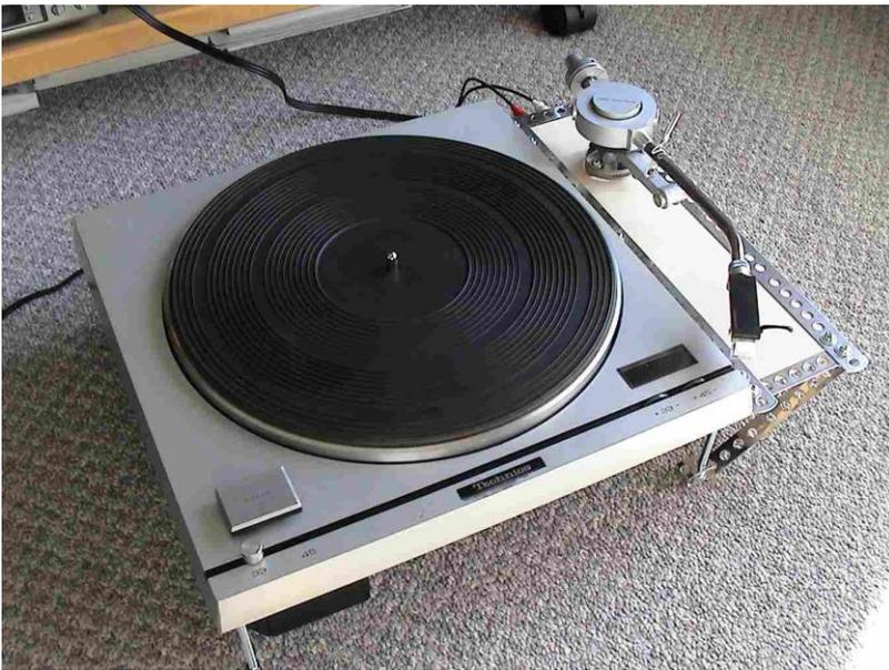
まずはともかく音を聴いてみたい、ということで同じくオークションでみつけた格安のマイクロ製トーンアーム(ジャンク扱い)とコンビにしてバラックのプレーヤに組み上げました。何せ、ターンテーブルモータ本体を入手するので大半の資金を使ってしまった。本式のプレーヤボード、ターンテーブル、DC ドライブアンプ／制御回路と積み上げるには、根気／時間／資金が足りん！このバラックセットをみたら金田先生はブっ飛ぶだろうなあ。邪道もいいところです。モーターベースを支えるため、5mmφ x 10cm の頼り無いビス4本を足に利用。アームベースの付けようがないので、このビスにもたせる格好でステンレスベルトをひん曲げて足場とし、そこへ1cm 厚の合板でできたアームベースを固定。「スケルトンプレーヤー」になってしまいました。しかし、そこから出てくる音にはびっくり。低音のハリがまるで違います。もとの DD プレーヤでは何となく歪みっぽく聴こえていた内周側の曲も底力が増した様です。
